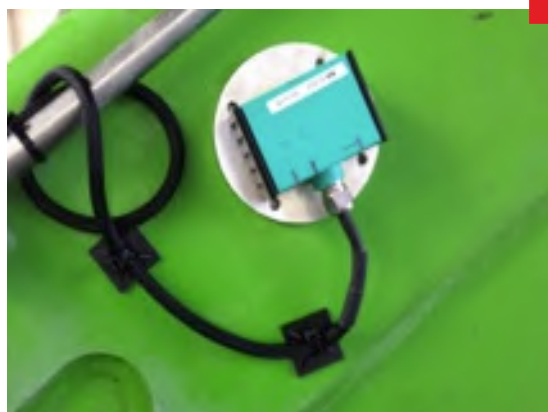
nové snímání polohy pomocí inklinometrů
