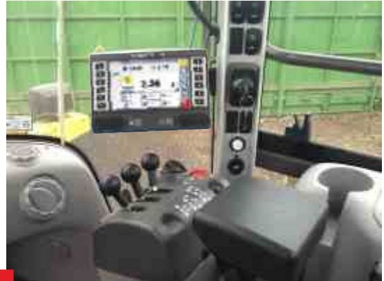
pohled do kabiny na vyhodnocovací jednotku LM ALFA 100i
